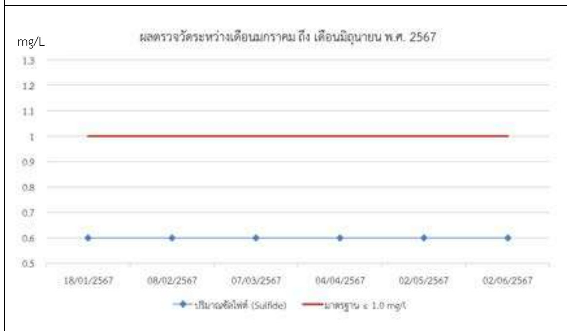
รูปที่ 4-16 กราฟการตรวจวัดคุณภาพน้ำทิ้ง (Wasts Water Quality) ปริมาณของซัลไฟด์ (Sulfide)
