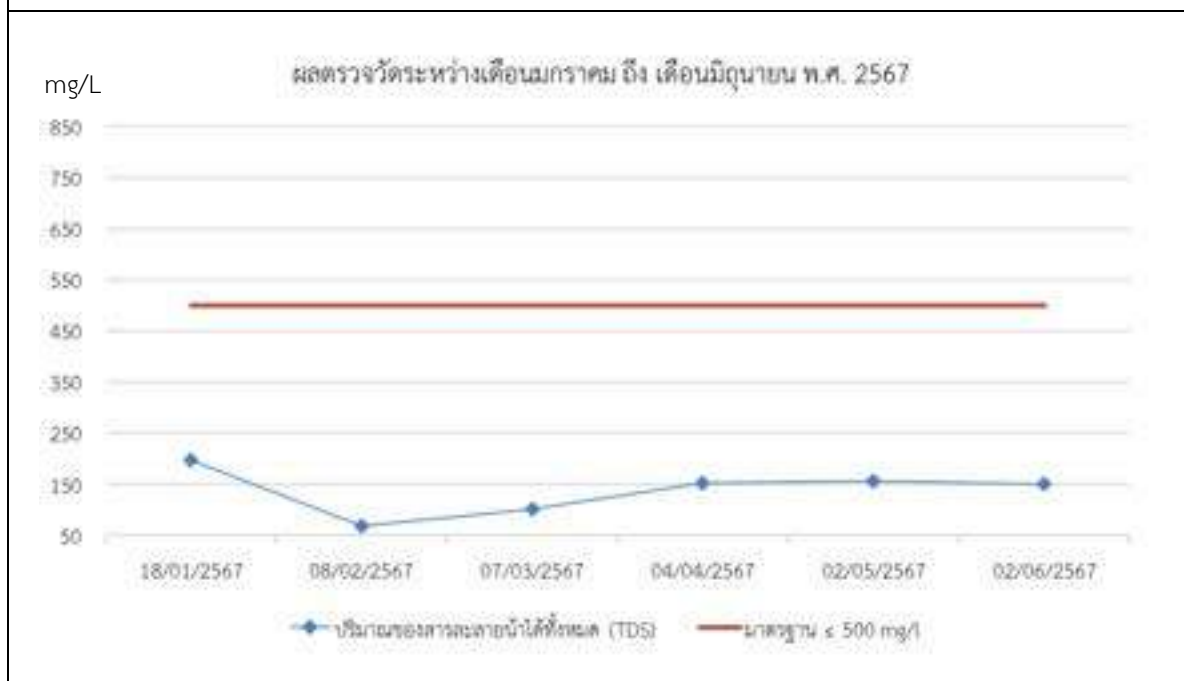
รูปที่ 4-12 กราฟการตรวจวัดคุณภาพน้ำทิ้ง (Waste Water Quality) ปริมาณของสารละลายน้ำได้ทั้งหมด (TDS)
