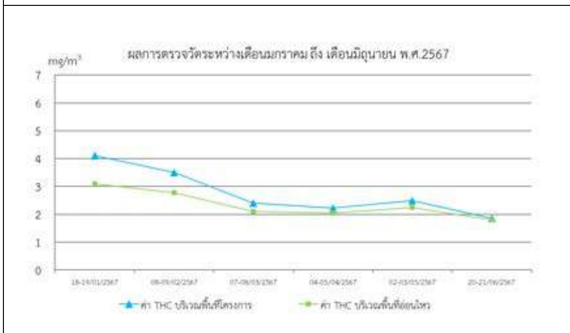
รูปที่ 4-7 กราฟแสดงผลการตรวจวัดคุณภาพอากาศในบรรยากาศโดยทั่วไป (Ambient Air Quality) ปริมาณไฮโดรคาร์บอน (Total Hydrocarbon; THC)
