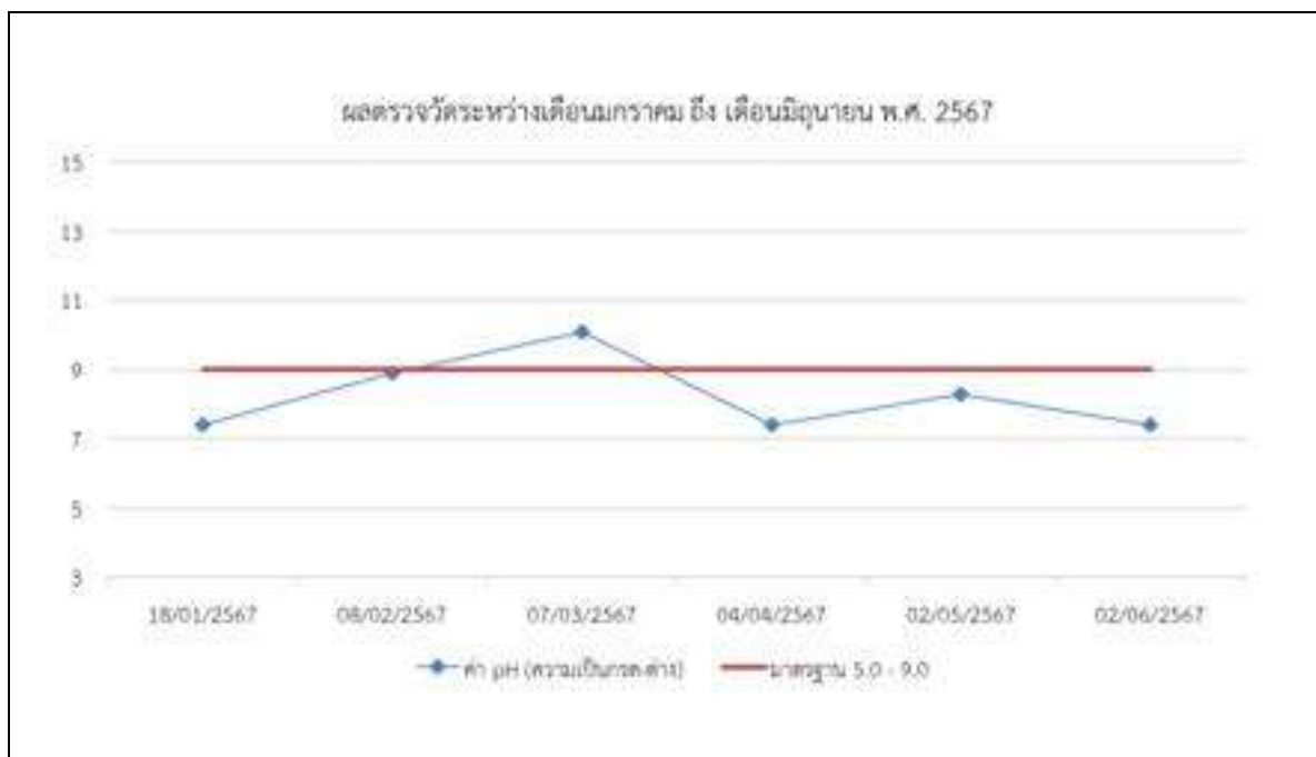
รูปที่ 4-11 กราฟการตรวจวัดคุณภาพน้ำทิ้ง (Waste Water Quality) ค่าความเป็นกรด-ด่าง (pH)
